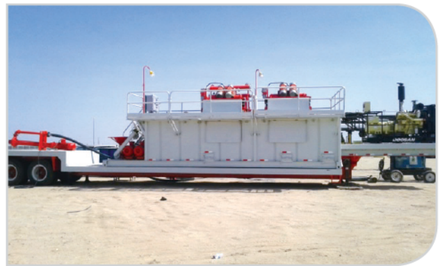
Pozo de agua para Perforación, Reciclaje de lodo
